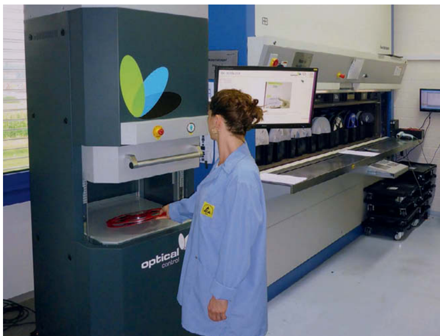
Fot. 1. Skaner rentgenowski CCX w Elektron Systeme – wszystkie wersje są dostarczane wraz z biblioteką komponentów, która umożliwia pracę urządzenia natychmiast po instalacji
