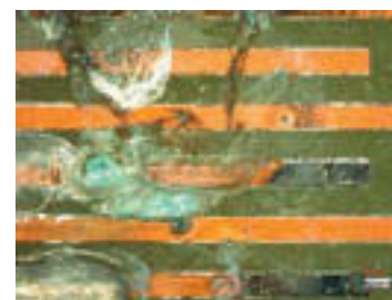
Rys. 2. Elektrochemiczna migracja spowodowana przez defekt powłoki ochronnej
