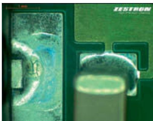
Rys. 6. Pozostałości niewidzialne (lewa strona), widzialne wskazane za pomocą Resin Test (prawa strona)
