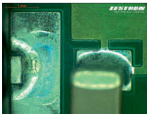
Rys. 5. Przewodzące pozostałości pomiędzy dwiema nóżkami
