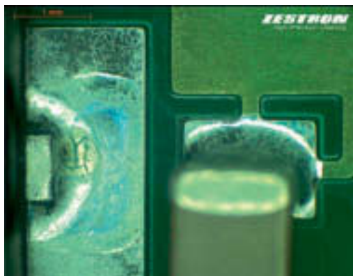
Rys. 4. Pozostałości aktywatorów, wskazane przez Flux Test (zmiana koloru na niebieski)
